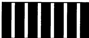
图 3 计时器调至 200 r/min 时的频闪线条
